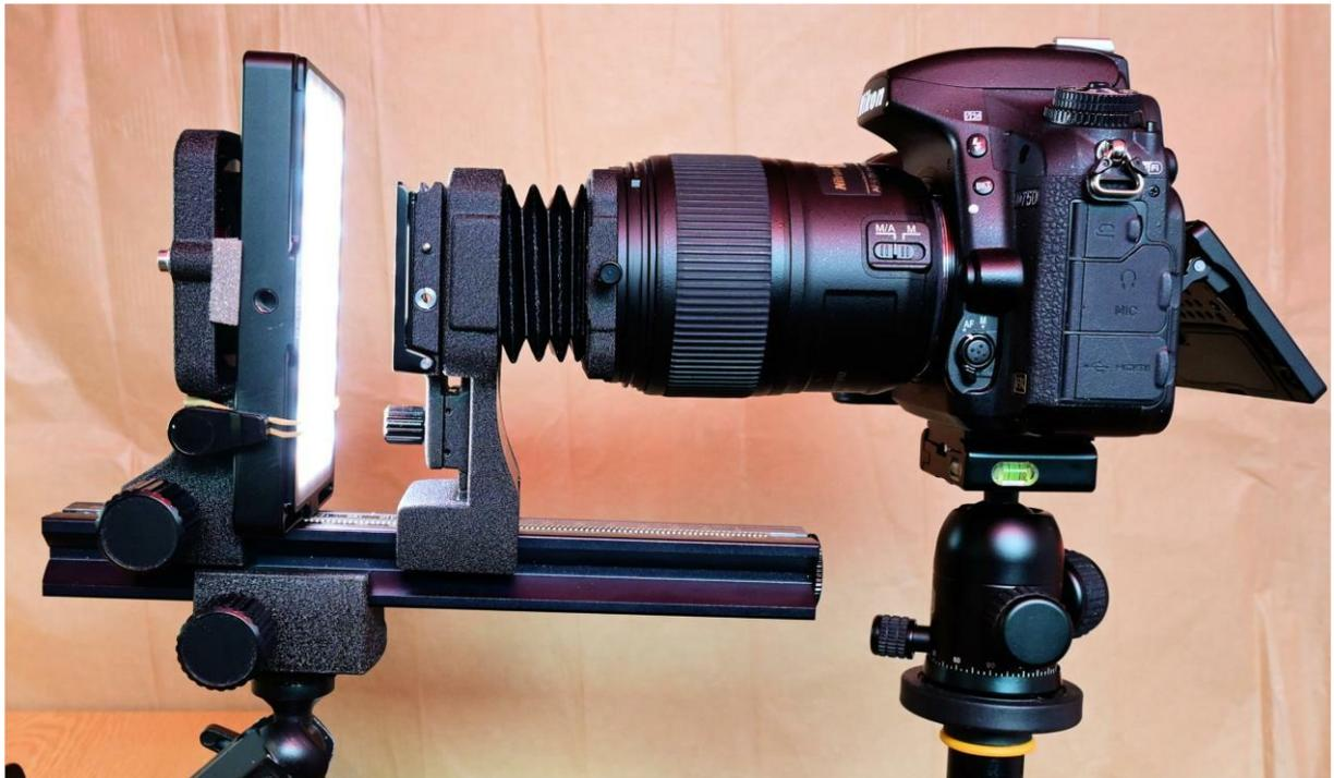
Die Kamera wird per USB (oder WiFi) mit "digiCamControl 2" <http://digidcamcontrol.com/> (sehr umfangreiche und mächtige, kostenlose Software!!) über den PC ferngesteuert. 24MP, automatischer Weissabgleich, Autofocus, direkte Speicherung der Bilder auf dem PC, super Dynamikumfang.
